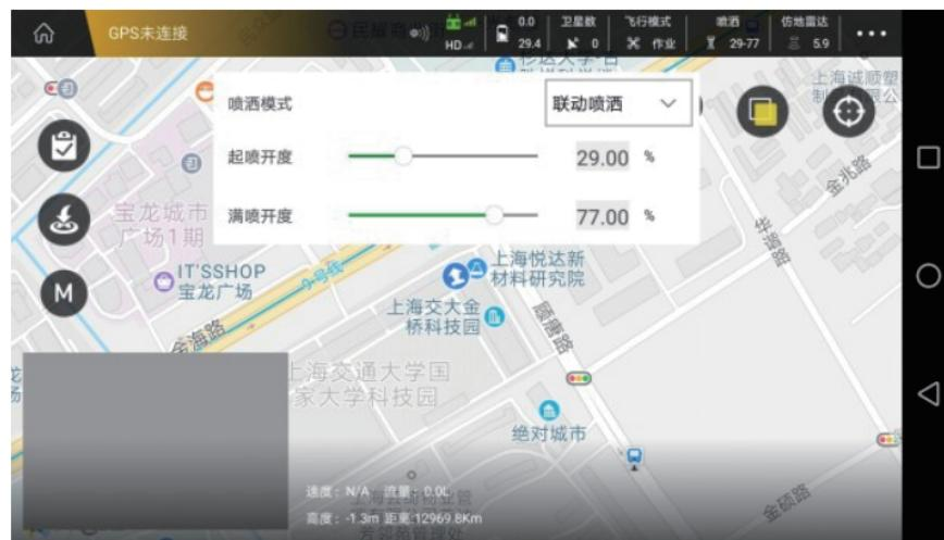
作业模式（AB作业、航线作业）在参数设置界面设置喷洒模式为联动，作业时飞控会自动进行水泵联动控制。
